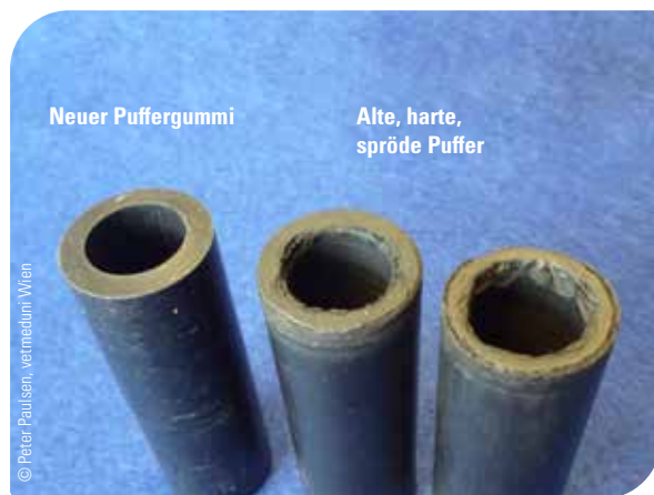
Abb. 10: Alte Gummipuffer müssen ausgetauscht werden
