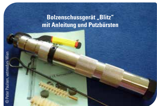
Abb. 6: Bolzenschussgerät Bauart „Blitz“ in ordentlichem Wartungszustand
