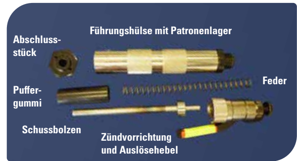
Abb. 4: Für Reinigungszwecke zerlegtes Bolzenschussgerät der Bauart „Blitz“ (© Peter Paulsen, vetmeduni Wien)
